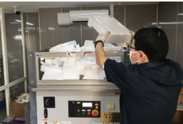
発泡スチロールを減容機によりインゴット化
