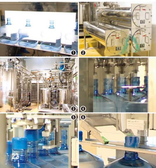
①空ボトル検査台 ②マイクロフィルター ③殺菌室 ④充填機 ⑤打栓機 ⑥シュリンクラベラー
